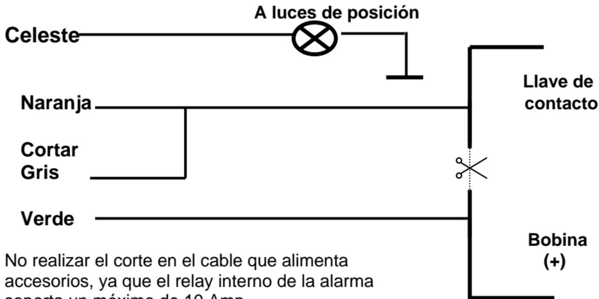
No realizar el corte en el cable que alimenta accesorios, ya que el relay interno de la alarma soporta un máximo de 10 Amp.
